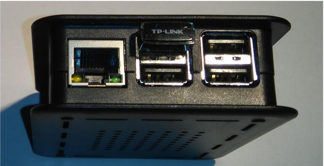
Im Bild gezeigt hier ein Raspberry Pi 3. Bei den neueren mit USB 3.0 (blaue Buchsen) muss er in der blauen Buchse auf der Leiterplatten-Seite stecken.
